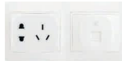
二位连体插座 型号：SFB-TE/SO/23-10A-01 特点：标准86mm×172mm面板,60mm安装孔距,250V10A,1个2+3插,1电话插座
