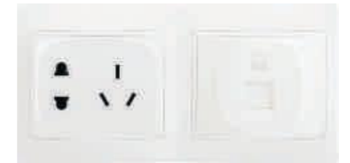
二位连体插座 型号：SFB-PC-SO-23-10A-01 特点：标准86mm×172mm面板,60mm安装孔距,250V10A,1个2+3插,1网络插座
