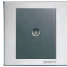
二分支电视插座 型号：SFC-TV-2-01 特点：86型面板,镀铬边框,不锈钢拉丝面 60.3mm孔距
