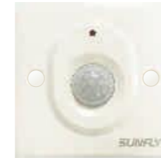
光敏红外人体感应开关 (三线) 型号: SFB-SW-HIL-100W-02 特点: 100W,220V~,三线,标准86面板, 60mm安装孔距,带光敏, 30LUX触发照度
