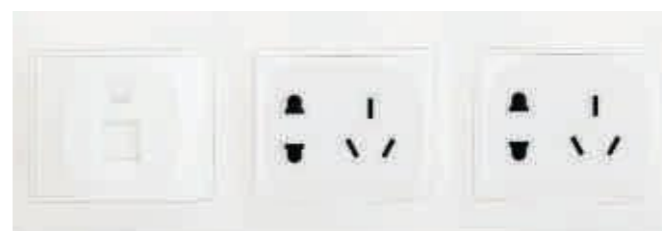
三连体组合式面板 型号：SFB-SO23*2+PC-01 特点：250V~10A,258*86mm面板， 两个二三插+单电脑插
