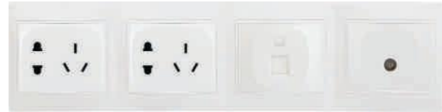
四位连体插座 型号：SFB-PC-TV-23-10A-01 特点：标准86mm×344mm面板,60mm安装孔距,250V10A,2个2+3插,1网络插座,1电视插座
