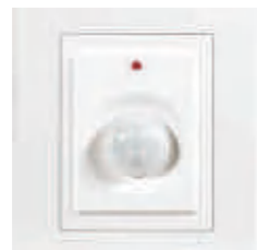
红外人体感应开关 (四线) 型号: SFB-SW-HIL-400W-01 特点: 400W-220V,四线,LED灯具400W, 60mm安装孔距带光敏, 30LUX触发照度
