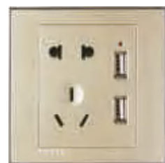
二三极插座 (带双USB) 型号: SFA-SO-USB2-10A-1 特点: 10A,250V,86型面板, 镀铬边框,双USB 5V 2A,
