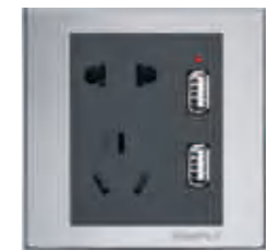
二三极插座(带双USB) 型号：SFC-SO-USB2-10A-01 特点：10A,250V,86型面板,镀铬边框,不锈钢拉丝面,双USB 5V 2A
