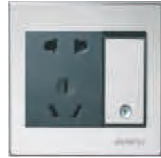
带开关二三极插座 型号：SFC-SO-23S-10A-02 特点：10A,250V,共零线,86型,镀铬边框,不锈钢拉丝面,带夜光指示
