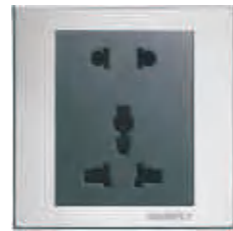
世界通用二三插座 型号：SFC-SO-23U-13A-01 特点：13A,250V,86型面板,镀铬边框,不锈钢拉丝面,带夜光指示
