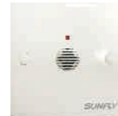
声光控开关 (四线) 型号: SFB-SW/SL-100W-03 特点: 100W-220V,65dB,30Lux触发照度, 四线,延时50s,86型白色
