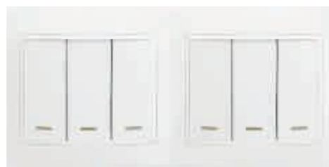
两连体组合式面板 型号：SFB-SW3*2-10A-01 特点：250V~10A,172*86mm面板, 两个三位单控开关
