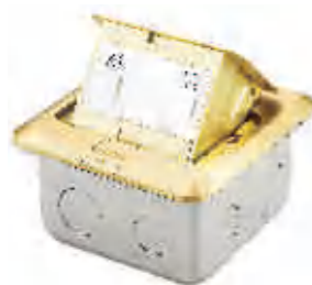
电话+八芯电脑信息地插座 型号：SFA-G-TE-PC-05 特点：120*120面板, 85mm安装孔距,铜面
