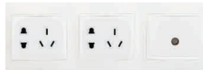
三位连体插座 型号：SFB-TV-SO-23-10A-01 特点：标准86mm×258mm面板,60mm安装孔距,250V10A,2个2+3插,,1电视插座
