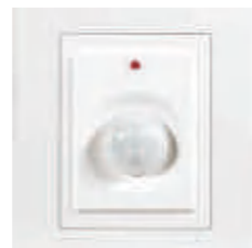
光敏感应开关 型号: SFB-SW/L-30W-01 特点: LED灯具30W,220V,三线, 标准86面板,60mm安装孔距, 纯光控,10LUX触发照度
