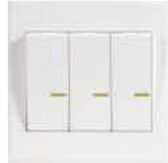
三位大跷板双控开关 型号：SFB-SWD-3-10A-02 特点：10A,250V,86型面板 白色,带夜光指示
