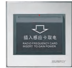
感应式插卡取电开关(高频) 型号：SFC-SW-CE-30A-04 特点：30A-250V,标准86面板,60mm安装孔距,不锈钢拉丝面,塑料底座,使用频率13.56MHZ
