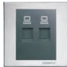
双电脑插座 型号：SFC-PC-2-04 特点：86型面板,镀铬边框, 不锈钢拉丝面,CAT6电脑模块
