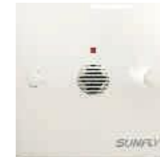
声光控延时开关 型号: SFB-SW/SL-100W-02 特点: 100W-220V,65dB,30Lux触发照度, 三线,延时50s,86型,白色
