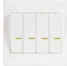
四位大跷板单极开关 型号：SFB-SW-4-10A-04 特点：10A,250V,86型面板 白色,带夜光指示
