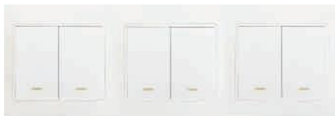
三连体组合式面板 型号：SFB-SW2*2+SWD2-01 特点：250V~10A,258*86mm面板， 两个二位开关+二位双控开关
