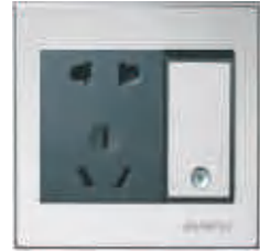
带双控开关二三极插座 型号：SFC-SO-23SWD-10A-01 特点：10A,250V,共零线,86型,镀铬边框,不锈钢拉丝面,带夜光指示
